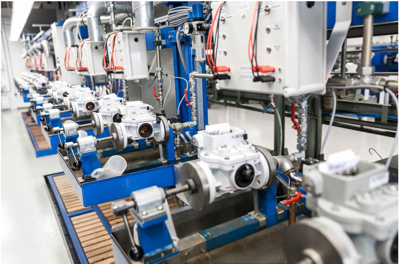
*Abb. 2: Funktions- und Dichtigkeitsprüfung bei der EMB Barleben.*
