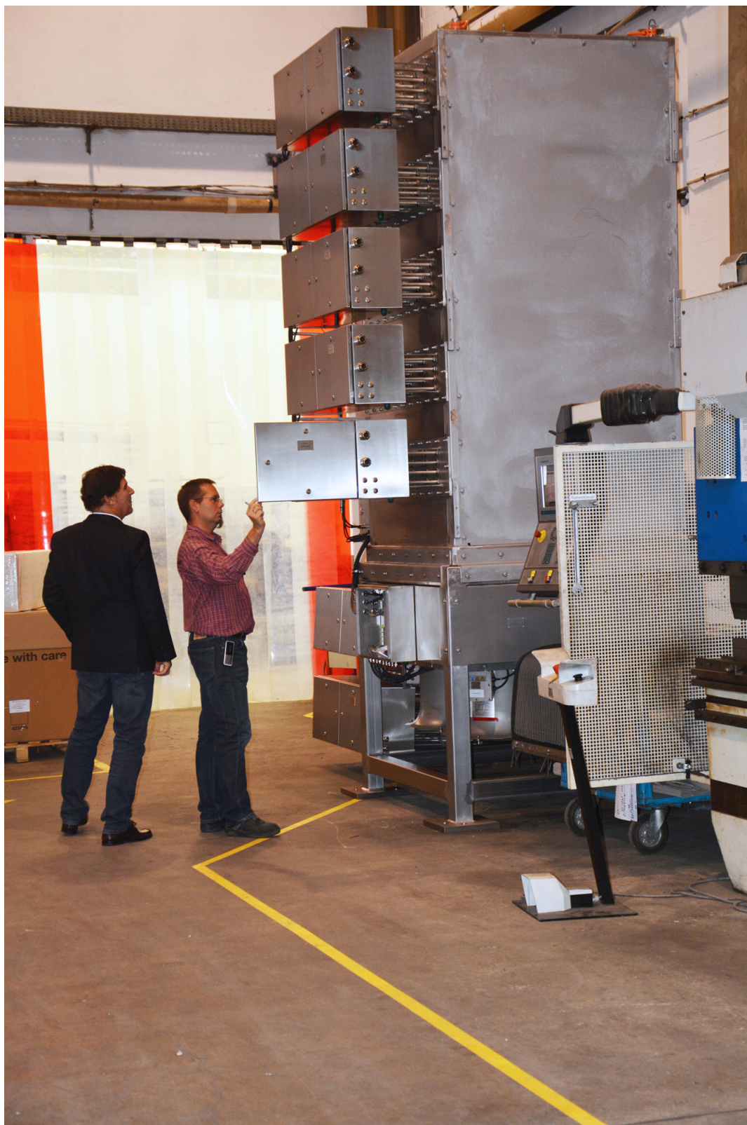
Abb. 3: Belastungswiderstand inklusive Wärmerückgewinnung für den Einsatz an einem Schiffsgenerator.
