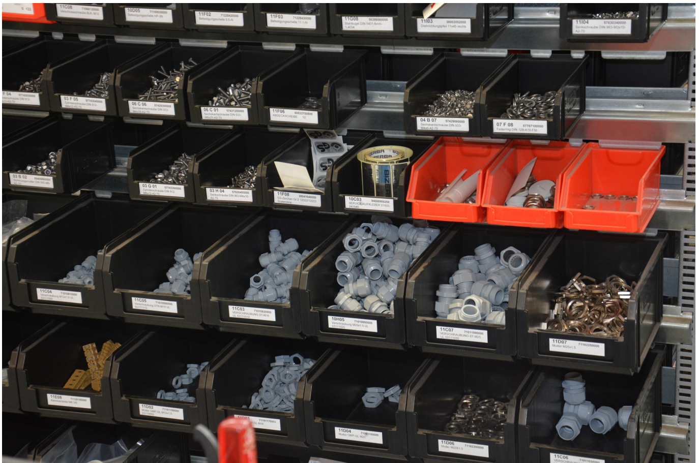
Abb. 4: Teile-Regal mit Jacob Kabelverschraubungen in einer Bizerba Fertigungsinsel
