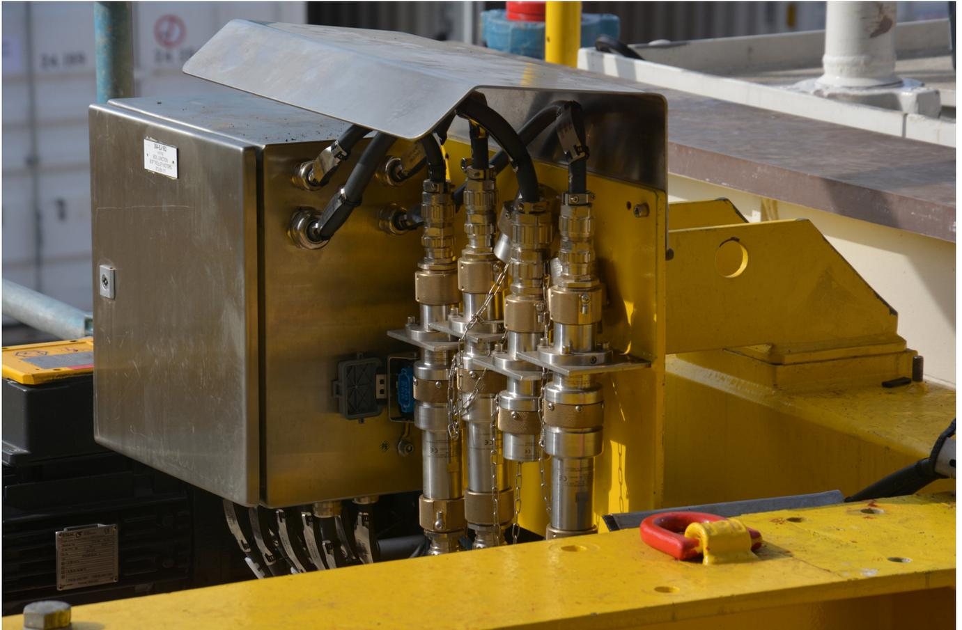
***Abb. 2: HAWKE Steckverbinder machen das modulare Konzept der Offshore-Tiefbohranlage VDD 400.2 möglich.***
