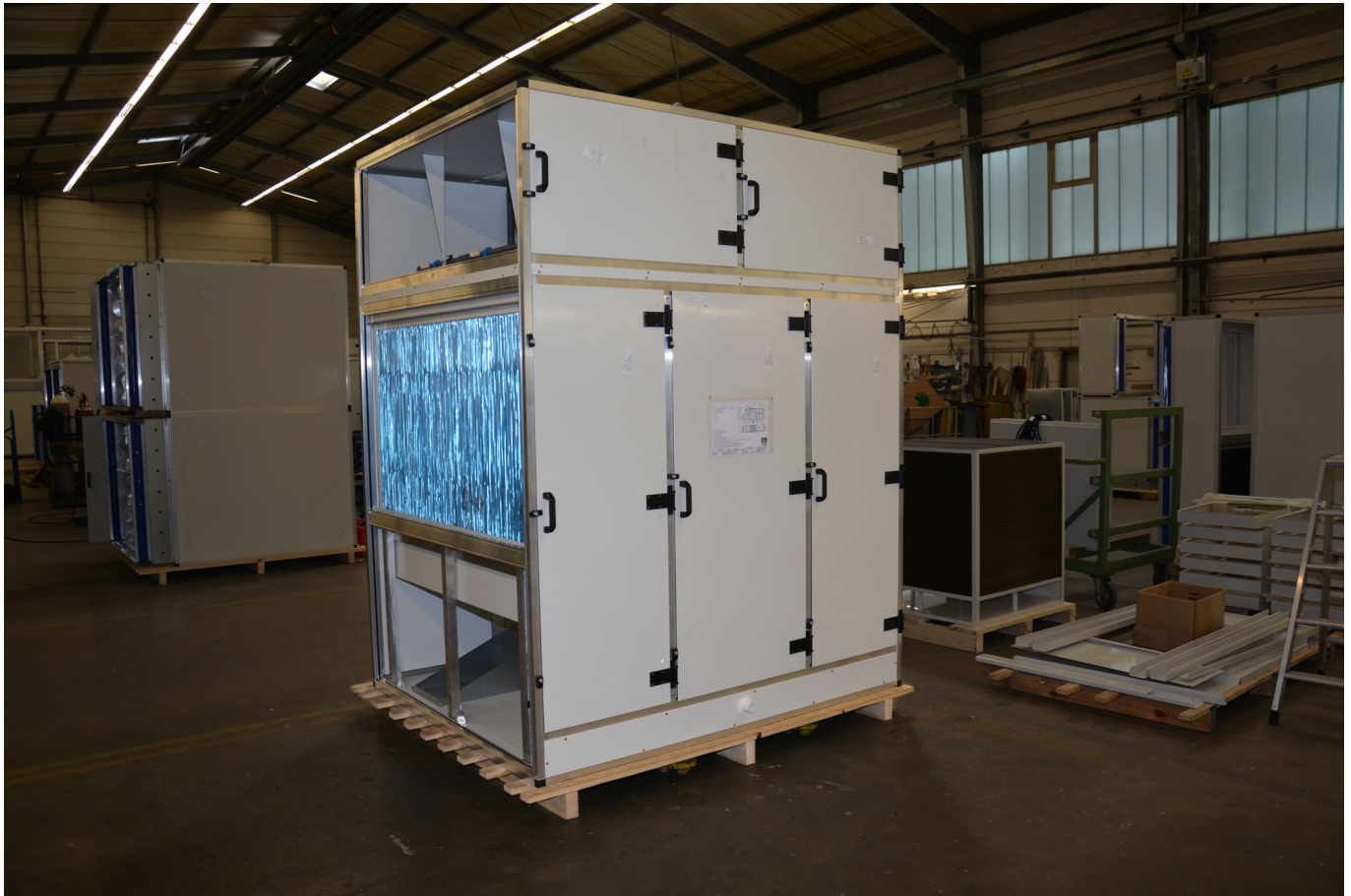
Abb. 4: Montage einer Lüftungszentral
