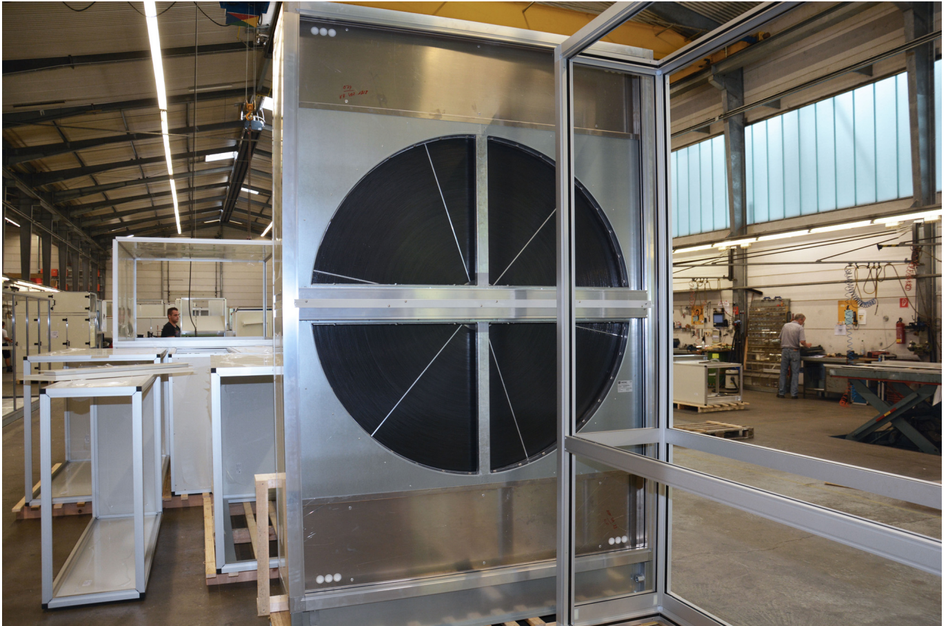
Abb. 5: Wärmerückgewinnungseinheit in der Fertigung
