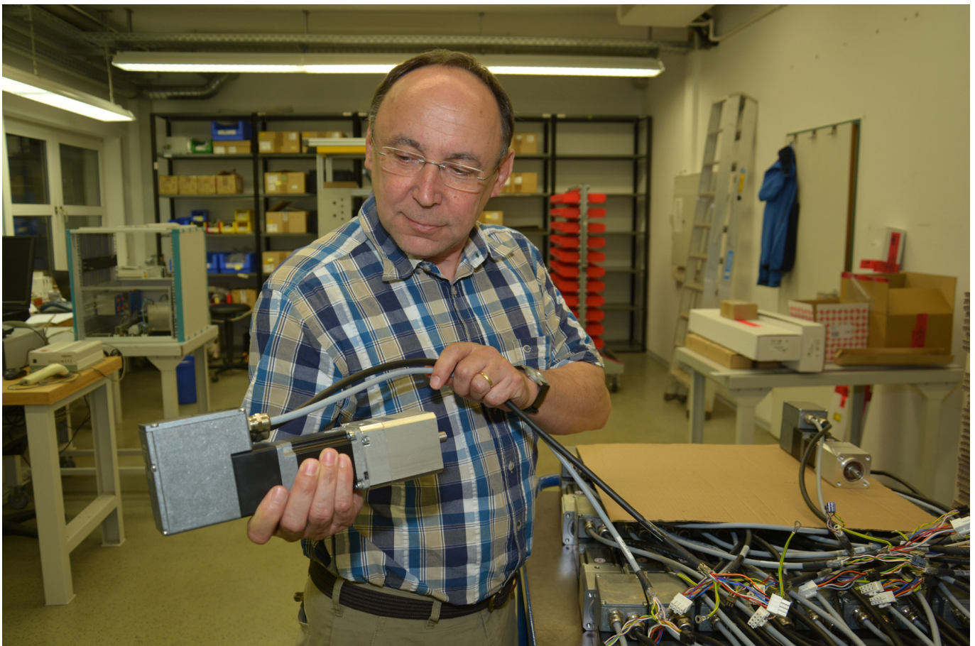
Abb. 2: Clemens Weißelburg, Produktmanager Servomotoren bei der Jenaer Antriebstechnik: Geschirmte Leitungen und EMV-Kabelverschraubungen sind Standard.
