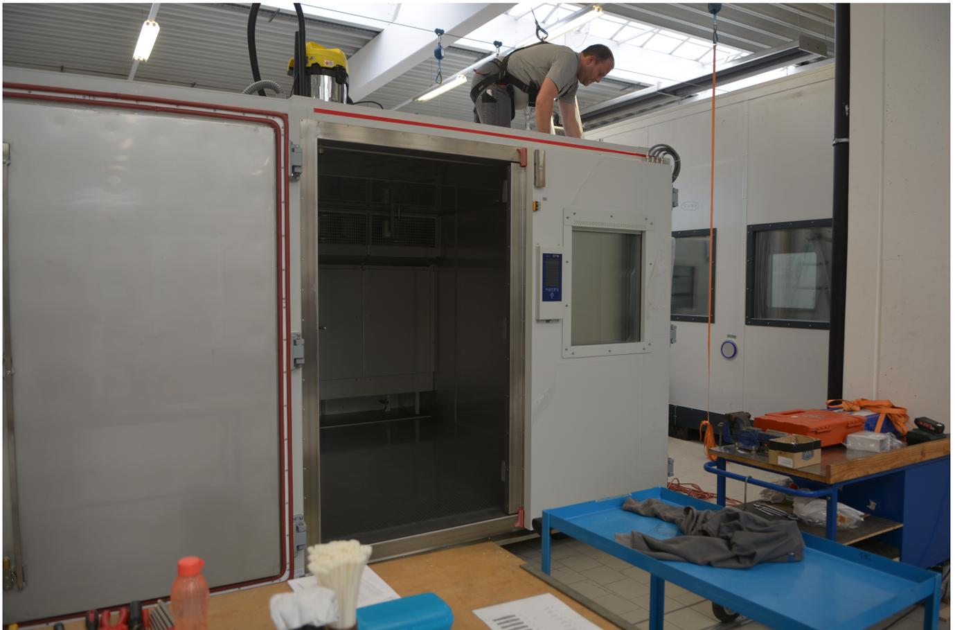
*Abb. 2: Blick in die Fertigung bei CTS. Montage einer begehbaren Klimakammer.*
